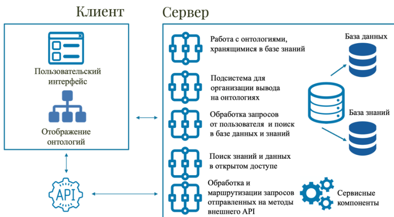
Рис. 4. Базовые компоненты и задачи онтологического портала
